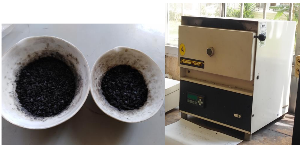
FIGURA 7 Muestra de carbón activado. Derecha mufla utilizada para el proceso.
