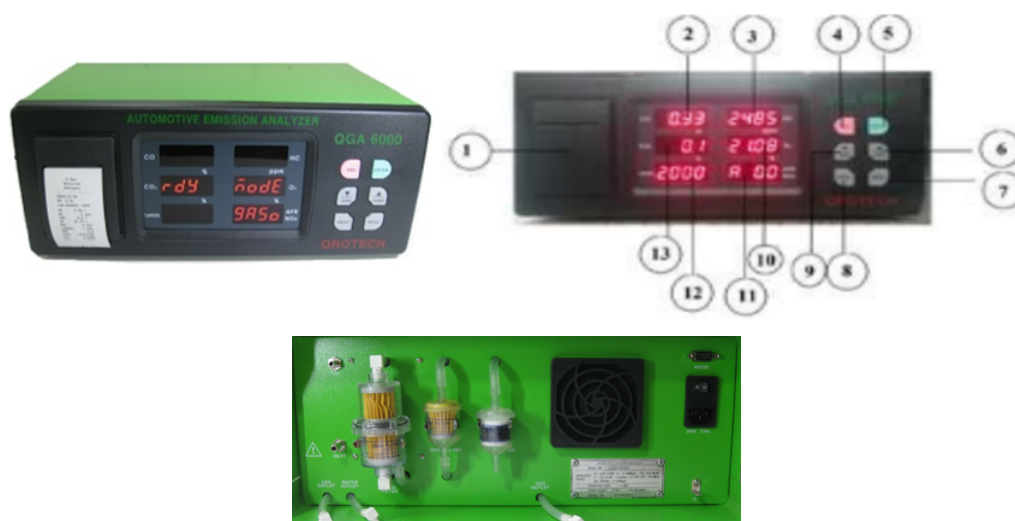
Figura 3.9: Equipo analizador de gases QROTECH Modelo QGA 6000. Adaptado de: Wonmi y colaboradores (2019)
