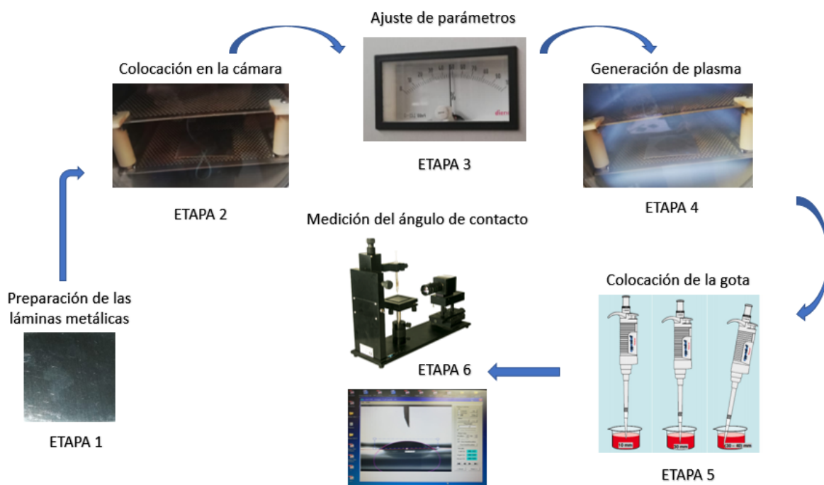
Figura 3.19: Procedimiento para determinar el ángulo de contacto. Fuente: Investigador
