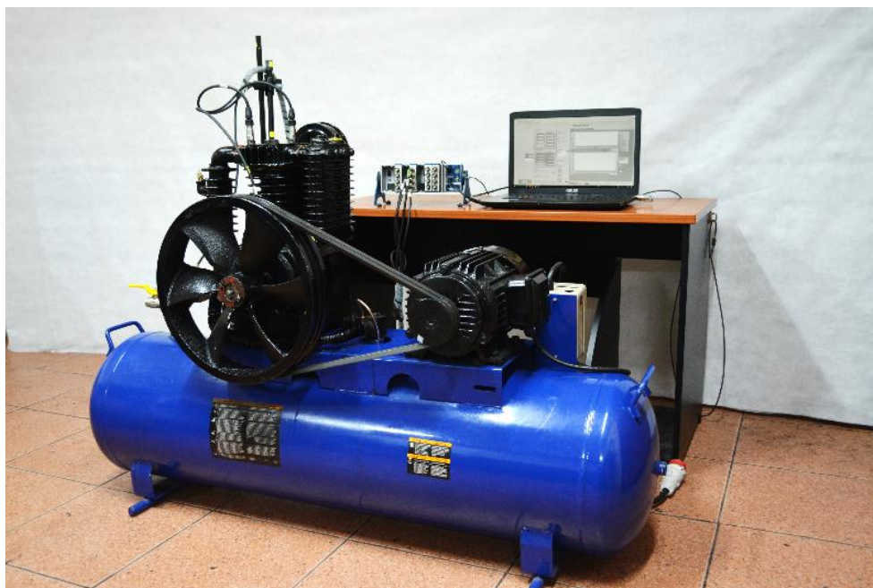
Figura 23. Compresor recíprocante de simple efecto doble etapa EBG250.
