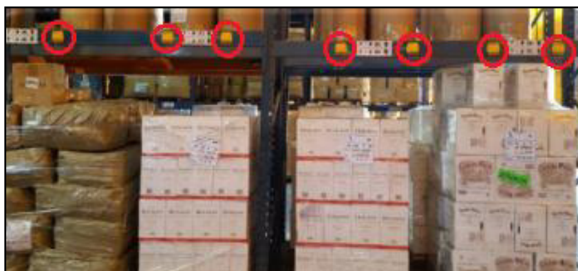
Figura 50. Ubicación de carga suelta y Tag pasivos. Fuente. Elaboración propia.
