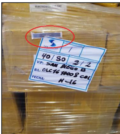
Figura 23. Ubicación del Tag RFID pasivo. Fuente. Elaboración propia.
