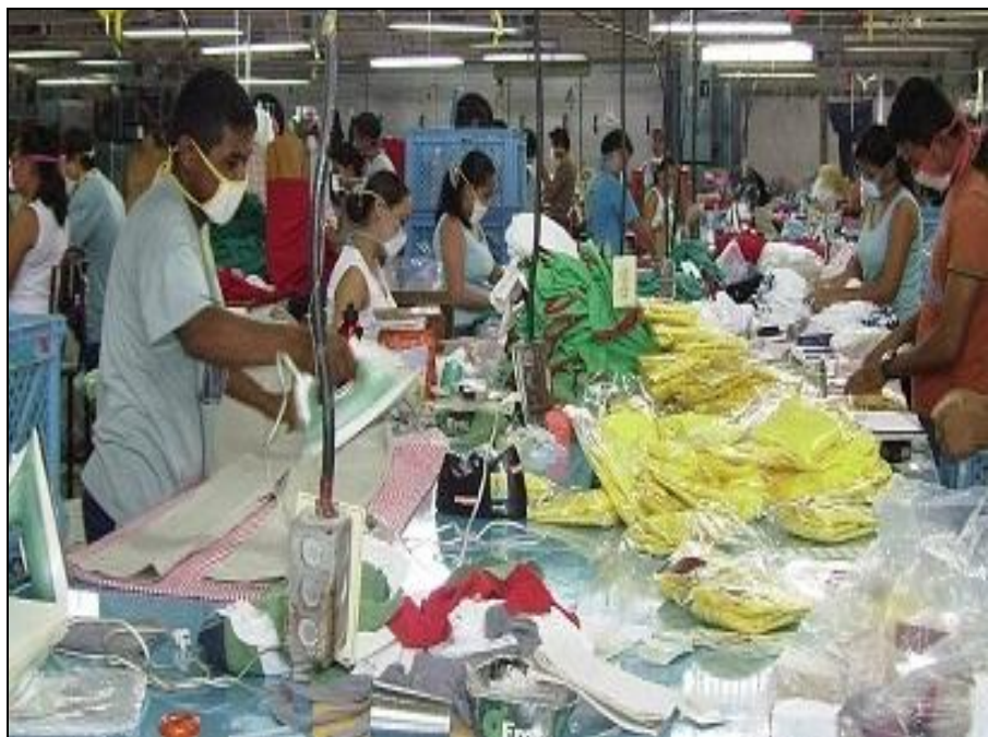
Figura N° 32. Altos niveles de inventarios en proceso. Elaboración Propia.
