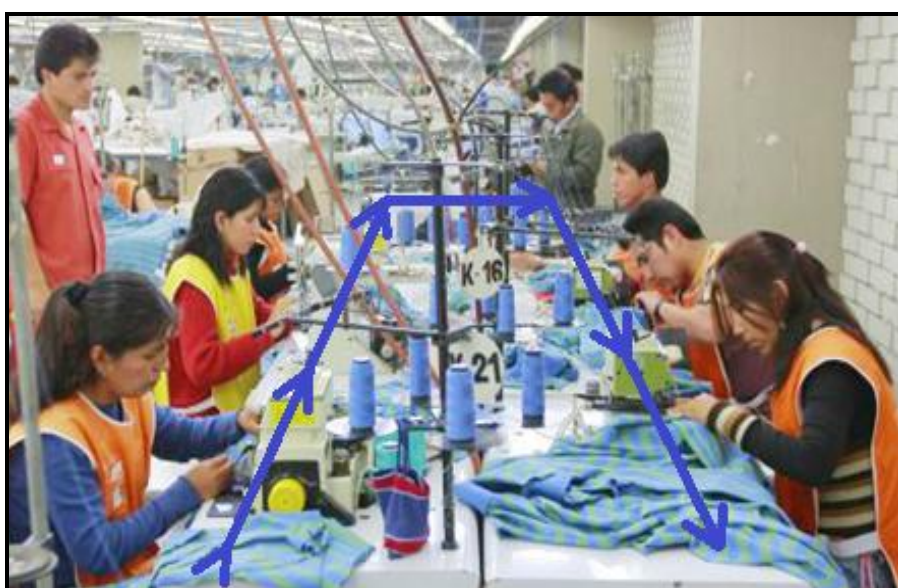
Figura N° 59. Líneas de trabajo distribuidas en U en espacios de menor área. Elaboración Propia.
