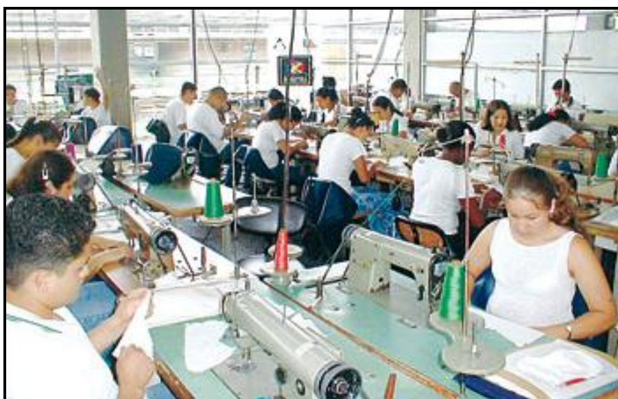
Figura N° 57. Célula de trabajo del sub-proceso de costura con personal operativo de 15 a 18 integrantes. Elaboración Propia.
