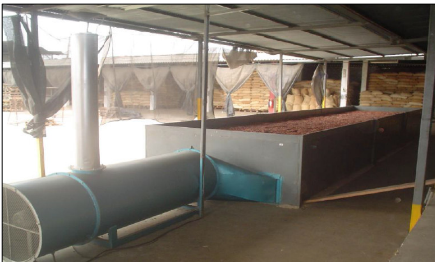
Figura 2 Secador de cacao artificial usando un horno de GLP Fuente: Elaboración propia
