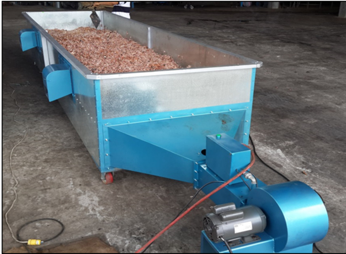
Figura 15 Secadora estática usando GLP como combustible Fuente: Elaboración propia
