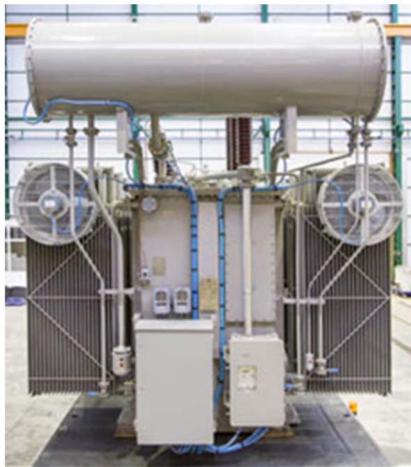
Figura 5. Transformador de Potencia de 6,5 MVA. Transformadores de Potencia (s.f.)
