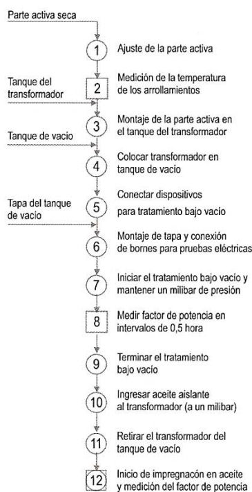
Figura 2. Diagrama del proceso de tratamiento bajo vacío.
