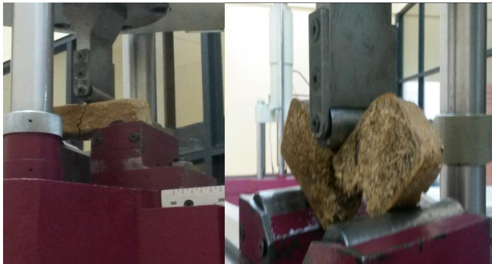
Figura 3.6. Procedimiento de toma de datos de resistencia a la flexión con carga transversal.
