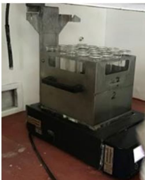
Figura 31. Tubos en el interior del digestor. Fuente. Elaboración propia.
