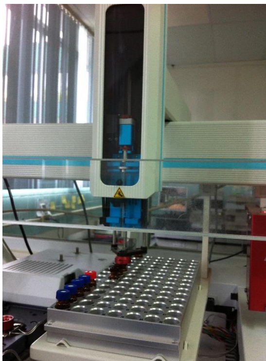
Figura 28. Inyección de muestras para la separación de ácidos grasos. Fuente. Elaboración propia.
