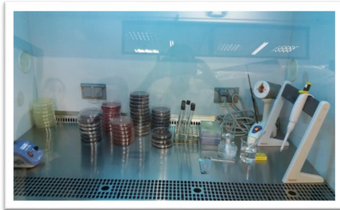
Figura 9: Cámara de Flujo Laminar Thermo Scientific 1300
