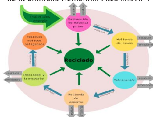
Figura N°8: “Coprocesamiento de residuos sólidos en el proceso de fabricación de clinker de la empresa Cementos Pacasmayo”.
