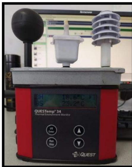
Figura 3. Medidor de Estrés Térmico QUESTemp° 34
