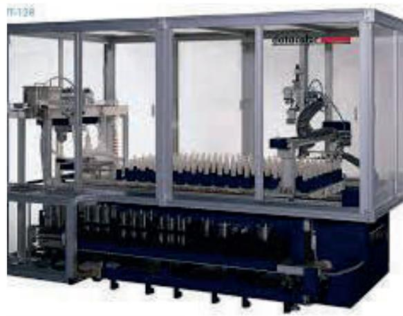
**Figura N.º 2.** td-lab laboratory dispenser realizando el pipeteo (Lawer,2019)
