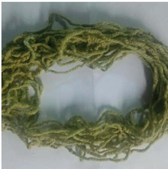
**Figura N.º 31.** Muestra después de ser sometida a prueba del lavado.
